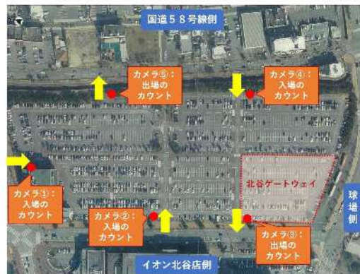
美浜駐車場における車両カウント用のカメラの設置箇所
