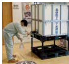
組立式の給水タンク
