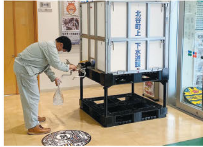
組立式の給水タンク
