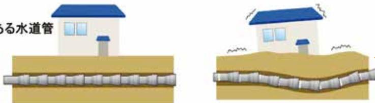
耐震管は、継手の部分が伸び縮みして抜けにくく、地震が起きたときに地面の揺れにも耐えることができ、漏水を防ぎます。
