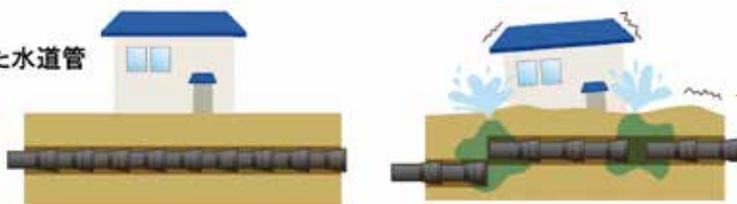
老朽化した水道管は、壊れたり、継手の部分から漏水が起こります。
