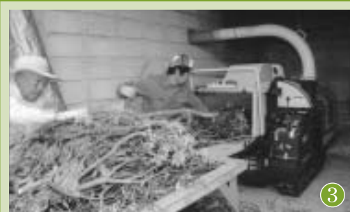
草木類資源化処理事業 ■収集された草木類を粉砕処理して堆肥をつくります。
